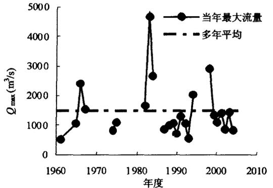
图7 蒋家沟逐年泥石流最大流量变化
