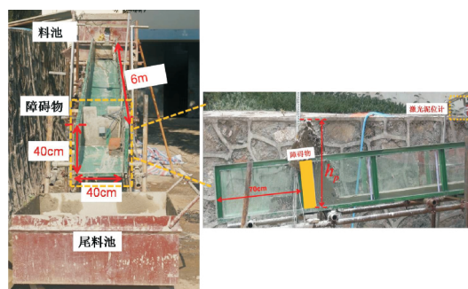
图8 实验水槽装置、障碍物位置及泥石流爬高
