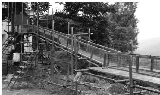
图1 泥石流动力过程模拟试验装置
