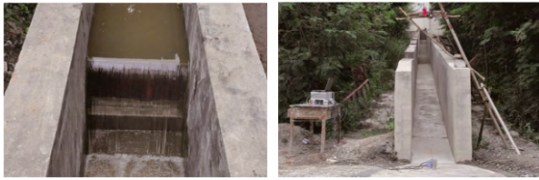
图1 大型水槽供水系统和实验装置
