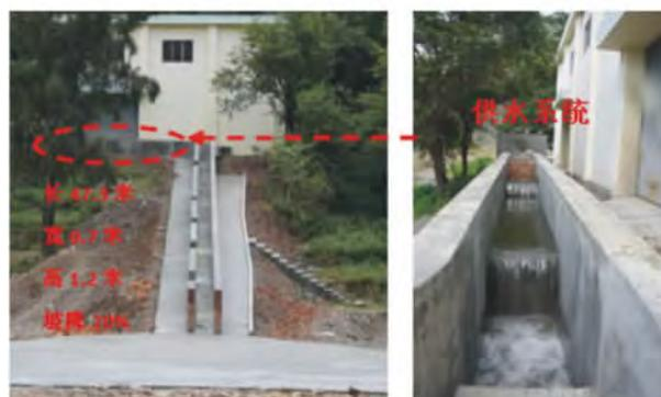
图 1 东川泥石流观测与研究站的大型实验水槽
