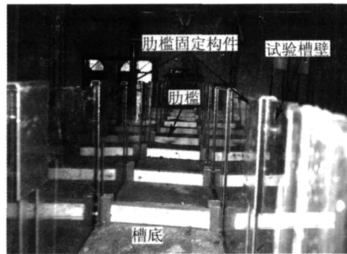
(b) “东川型”实验槽内消能工布设
