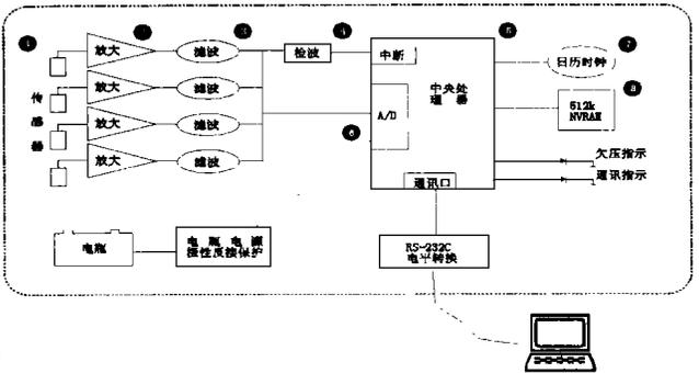
图1 泥石流地声参数检测仪电路系统框图
